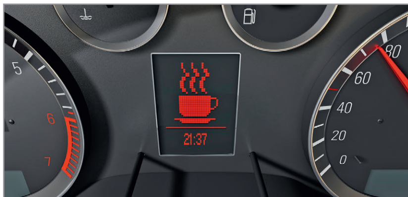
Рис. 7. Распознаётся усталость водителя – визуальный сигнал дополняется звуковым
