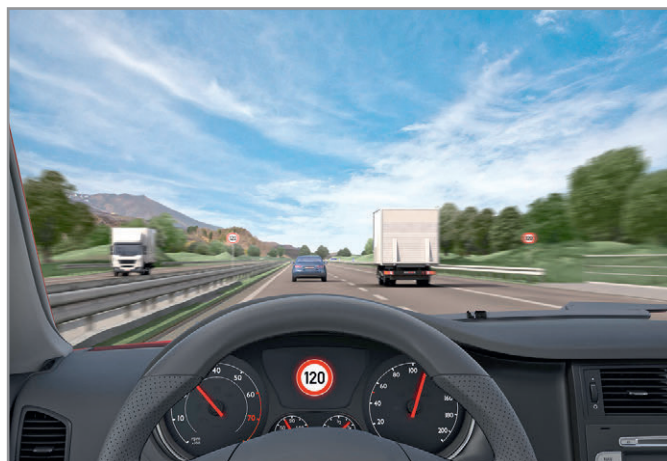
Рис. 3. Своевременная подача информации о действующем на данном участке дорожном знаке
