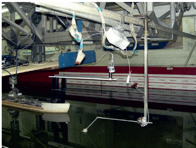
Рис. 3. Размещение ультразвукового датчика на выносной консоли, закреплённой на носу модели, и поплавкового волномера
