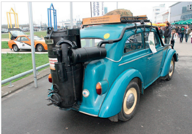
Рис. 2. Автомобиль с газогенераторной установкой
