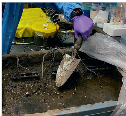
Рис. 4. MFC для грунтов и ила, насыщенных микроэлементами со свойствами биоразложения
