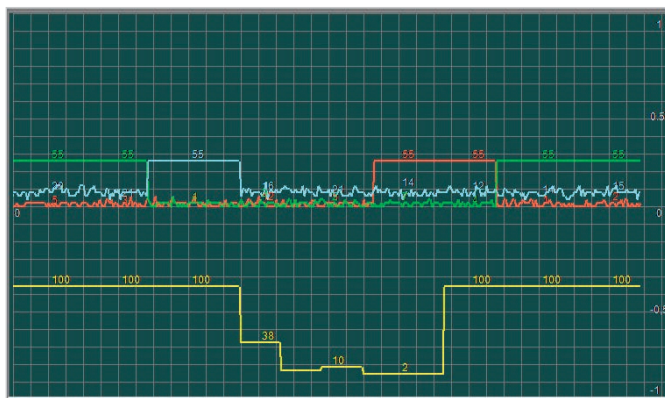
Рис. 4. Модель NanoEdge AI Studio, обученная на сигнале оси Y = 55 и значениях шума на осях X, Z
