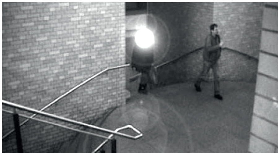
Рис. 4. «Пятно засветки» на изображении, полученном со старой видеокamеры
