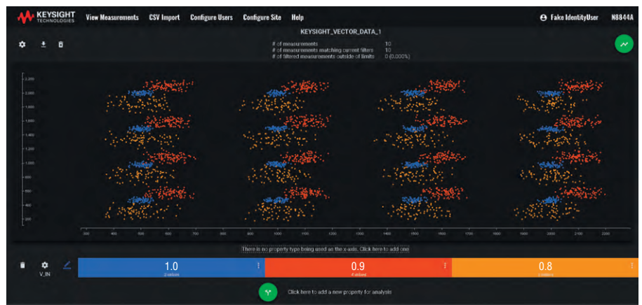
Рис. 1. Совмещение сигнальных созвездий 5G QAM4 для трёх разных входных напряжений (1; 0,9 и 0,8 В)
