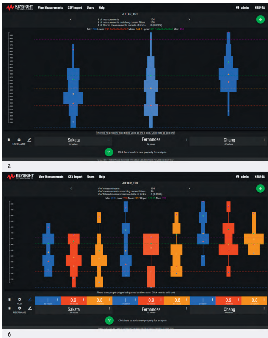
Рис. 2. Диаграммы измерения джиттера типа «ящик с усами» с функцией многоуровневого разделения: а) разделение по именам пользователей; б) разделение по именам пользователей и входному напряжению
