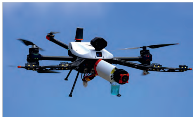
Рис. 4. Внешний вид дрона-манипулятора для забора проб воды
