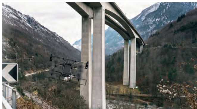
Рис. 2. Устройство для проверки бетонных конструкций и проведения регламентных работ [9]
