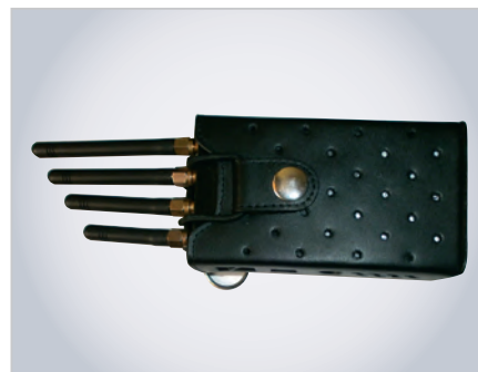
Рис. 10. Пример устройства глушения радиочастот для нейтрализации дронов малого форм-фактора
