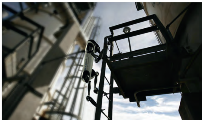
Рис. 1. Дрон-манипулятор для регламентных работ на ЛЭП
