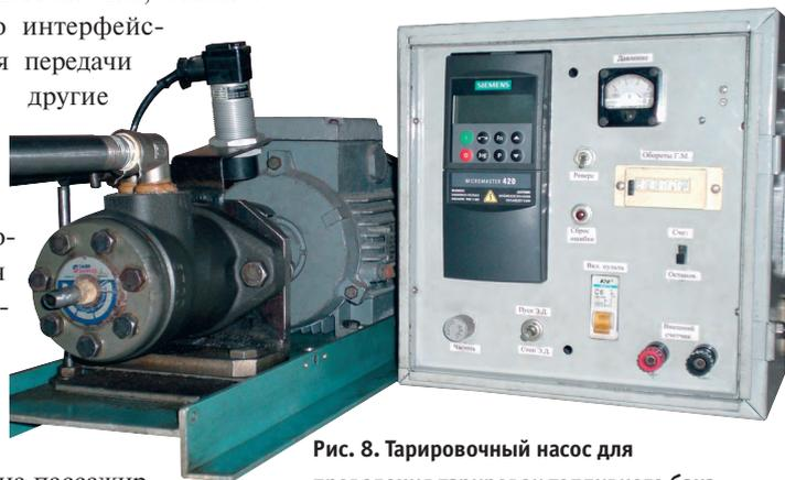
Рис. 8. Тарифовочный насос для проведения тарифовок топливного бака
