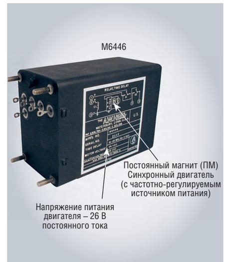
Рис. 7. Таймер с моторным приводом постоянного тока на рабочем напряжении 26 В
