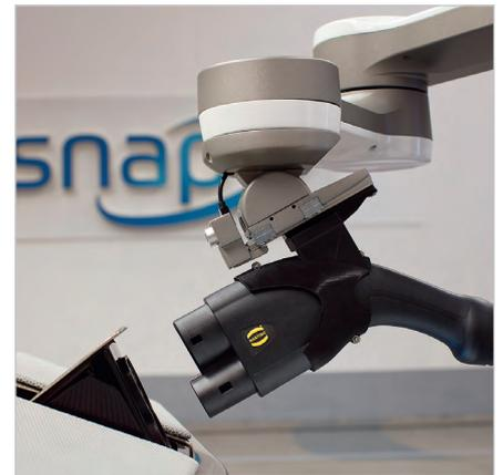
Рис. 4. Разъём Harting для подзарядки электромобиля metroSnap
