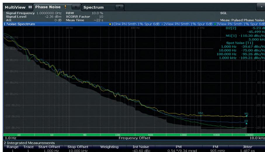
Рис. 6. Вариации фазового шума, вызванные изменением длительности импульса
