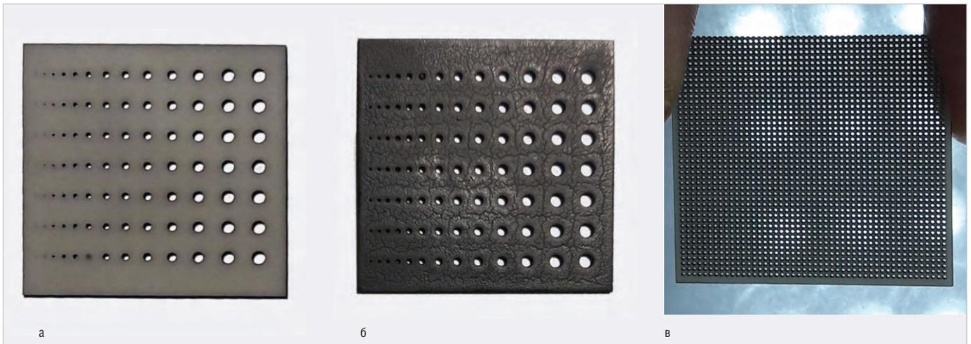
**Рис. 2. Алюмонитридные тестовые подложки с отверстиями:** а) исходная подложка после лазерной прошивки отверстий диаметром от 0,1 до 1,2 мм; б) подложка с отверстиями диаметром от 0,1 до 1,2 мм после наращивания слоя поликристаллического алмаза; в) алюмонитридная подложка с отверстиями диаметром 0,3 мм
