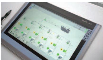
Рис. 3. Интерфейс оператора установки разгрузки автотранспорта на 6 постов
