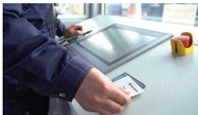
Рис. 7. Идентификация пользователя в АСУ ТП битумного терминала
