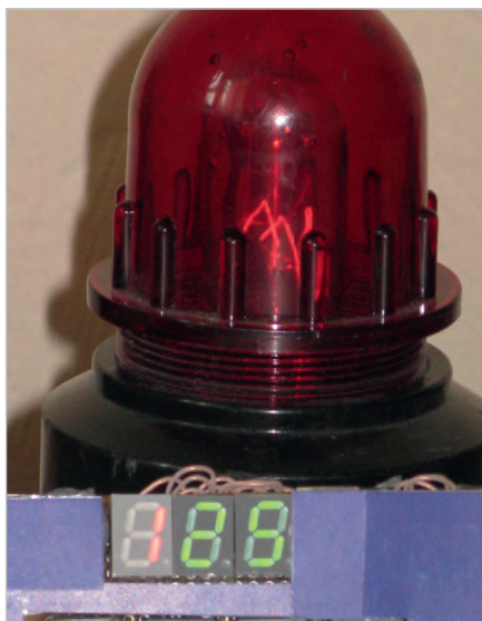
Рис. 15. Фотография светильника устройства с заданным относительным значением –25 для канала № 1
