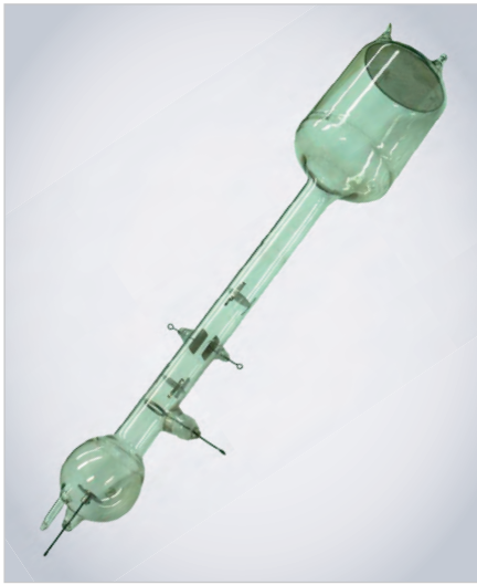
Рис. 6. Приёмная трубка Розинга для «Телефонта», 1907 год
