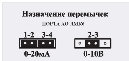
Рис. 2. Назначение перемычек ЛМК6
