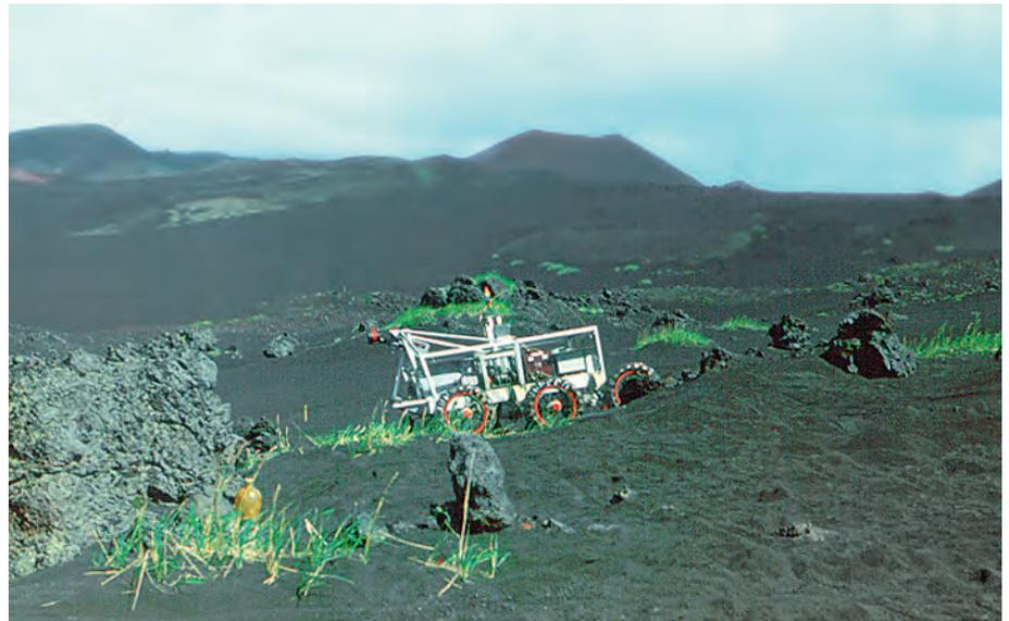
Рис. 4. Процесс испытаний прототипа интеллектуального мобильного робота-планетохода на Камчатке
