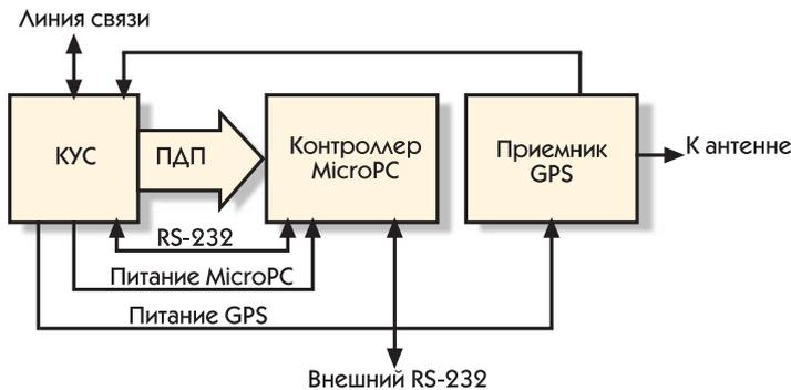
**Рис. 3. Структура узловой станции**
