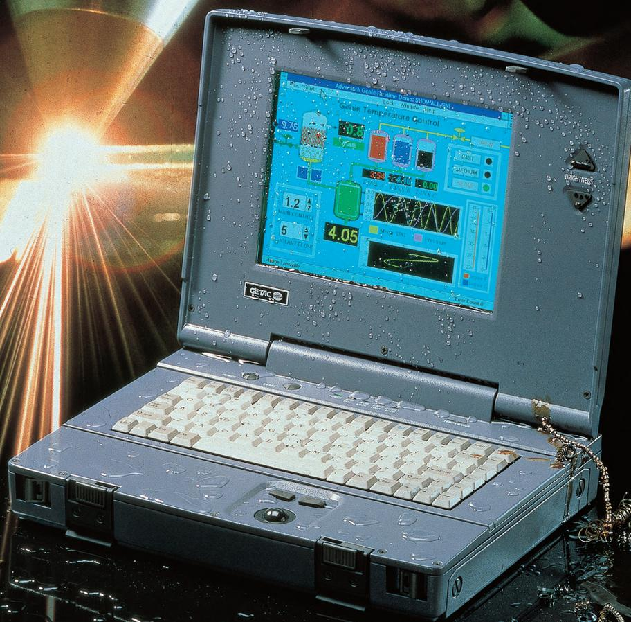
Облегченные портативные компьютеры GETAC разработаны специально для использования в неблагоприятных условиях промышленной эксплуатации внутри и вне помещений. Защищенный от погодных условий литой алюминиевый корпус способен успешно противостоять таким агрессивным воздействиям, как:
