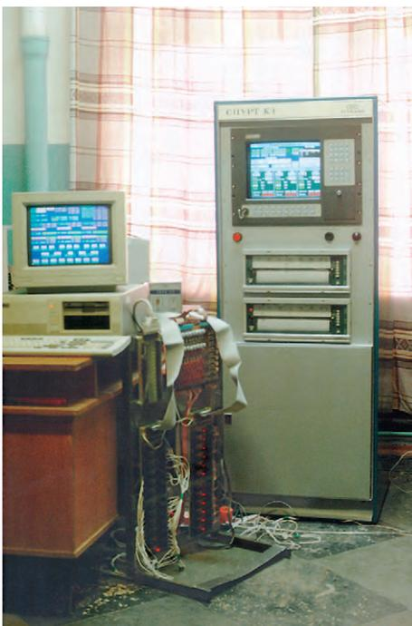
Рис. 2. Внешний вид системы программного управления и регулирования температуры
