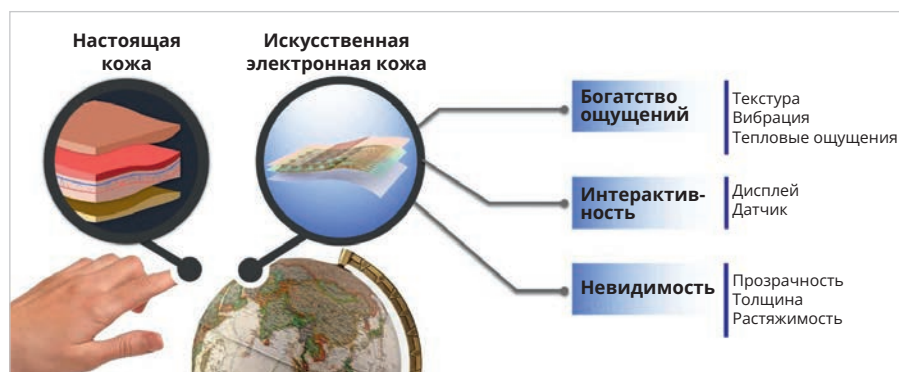
Рис. 6. AE-Skin обеспечивает интерфейс между кожей человека и физическими поверхностями
