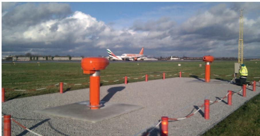
Рис. 7. Трансмиссометр AGVIS 2000
