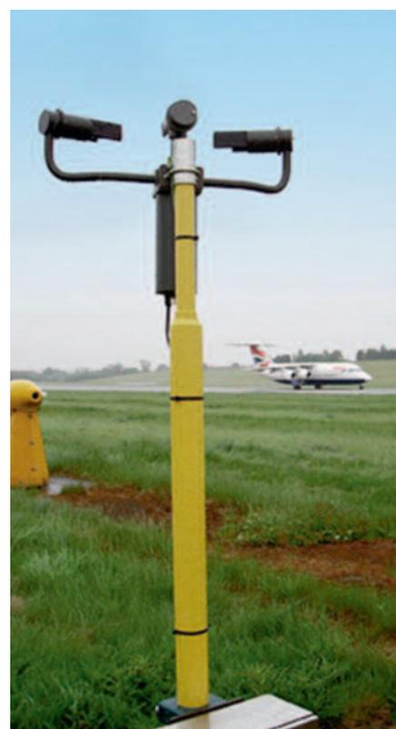
Рис. 6. Рассеиватель типа AGVIS FSI
