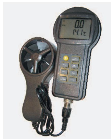
Рис. 2. Переносной анемометр для измерения скорости воздушных потоков (ветра) в широком диапазоне 0,02...30 м/с
