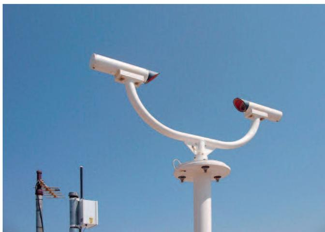
Рис. 3. Электронная система с датчиком PWS, штат Невада, США
