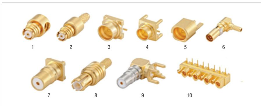
**Рис. 6. Немагнитные соединители компании Rosenberger:** 1 – угловая кабельная розетка SMP; 2 – прямая кабельная розетка SMP; 3 – вилка SMP для поверхностного монтажа; 4 – вилка SMP для монтажа в отверстия печатной платы; 5 – концевая вилка SMP; 6 – кабельный контакт SLC; 7 – прямая розетка QMA для поверхностного монтажа; 8 – прямая кабельная розетка QMA; 9 – угловая кабельная розетка QMA; 10 – 8-канальный модуль Insert Mini-Coax
