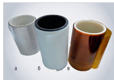
Рис. 1. Полимерные плёнки: а) ПЭТ (лавсановая, майларовая); б) фторопластовая; в) полиимидная
