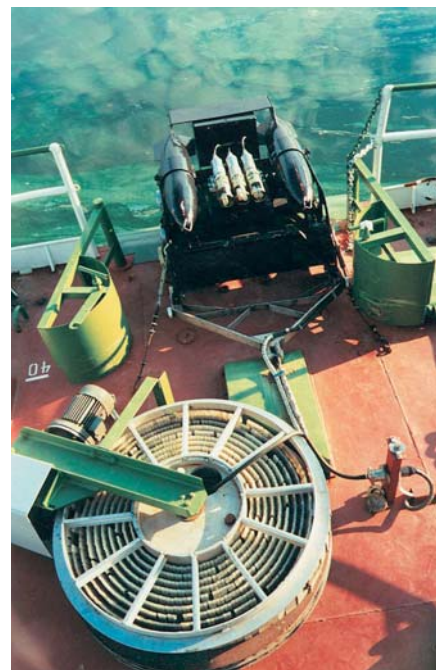
Рис. 5. Углубитель и датчики буксируемого устройства
