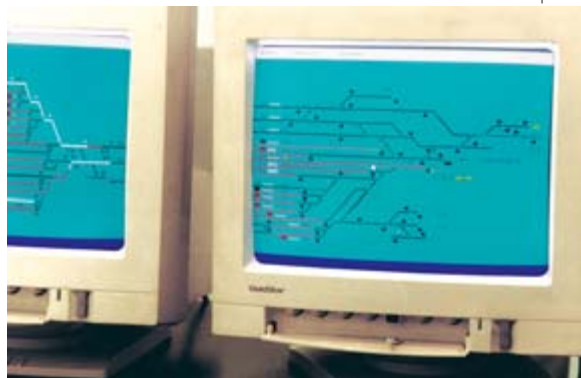
Отображение поездной обстановки на станции
