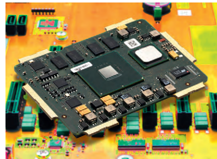
Рис. 9. XM1L – система на модуле, выполненная в стандарте ESMexpress® на базе процессора Intel® Atom™ XL
