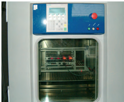
Рис. 5. Тестирование на устойчивость к воздействию климатических факторов
