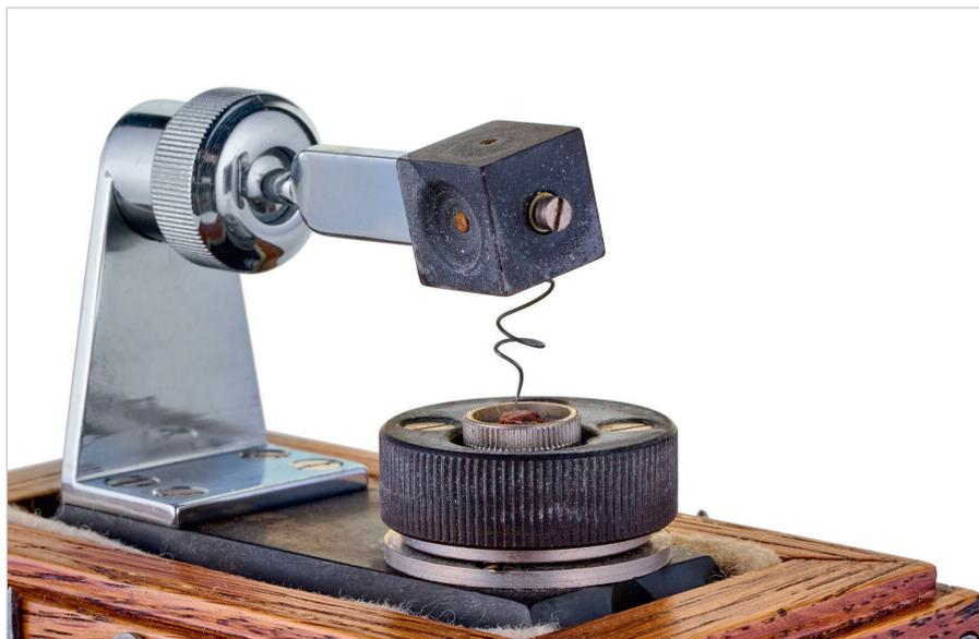
Рис. 4. Иллюстрация опытной установки «кошачий ус»
