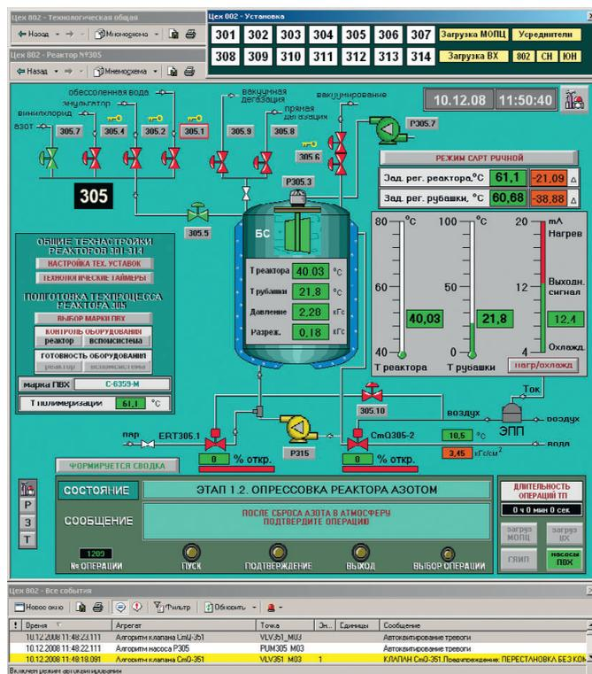
Рис. 8. Мнемосхема реактора
