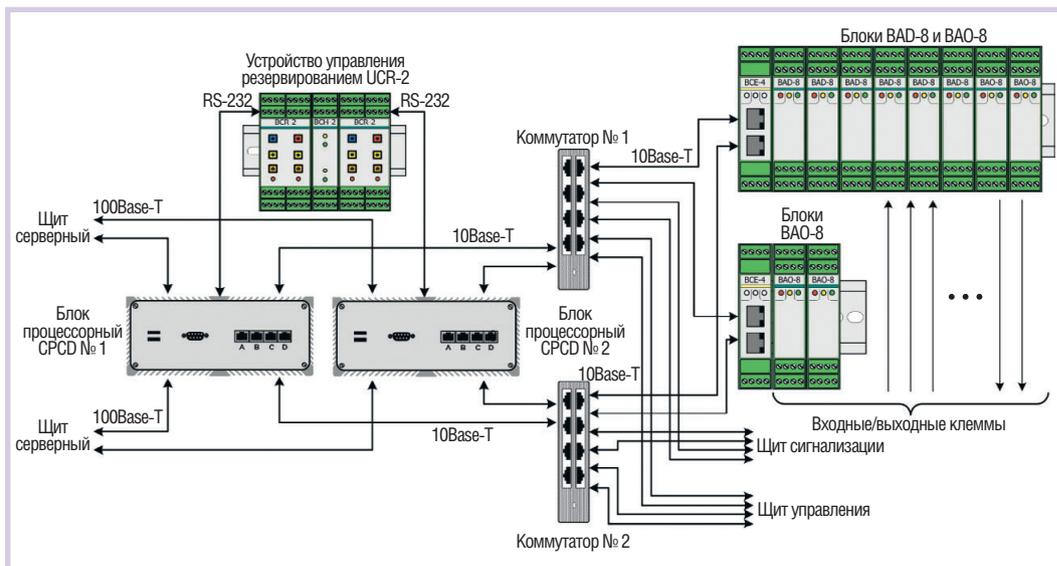
Рис. 2. Структура связей резервированного оборудования центрального щита
