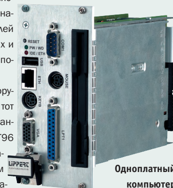
Конструктивы, выполненные в стандарте Евромеханика
