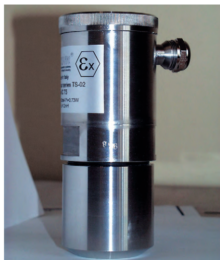
Рис. 1. Акустический уровнемер TS-02
