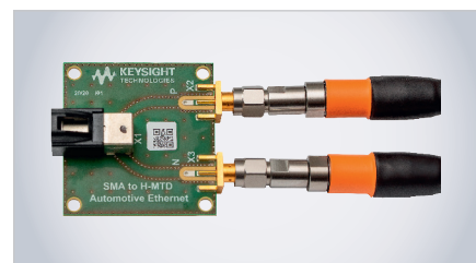
Рис. 4. Пример соединителя MDI с H-MTD и SMA
