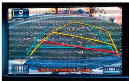
Рис. 3. Изображение с камеры заднего вида с разрывами передачи
