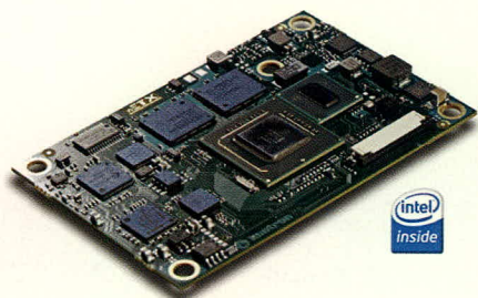
Рис. 1. Сверхмалопотребляющий процессорный модуль Kontron nanoETXexpress-SP, несущий на себе новейший x86-совместимый процессор Intel Atom Z5xx и имеющий размеры 55 × 84 мм
