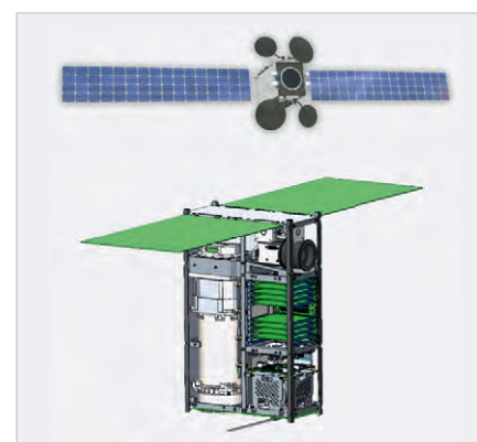
Рис. 6. Внешний вид и схема расположения отсеков малого спутника
