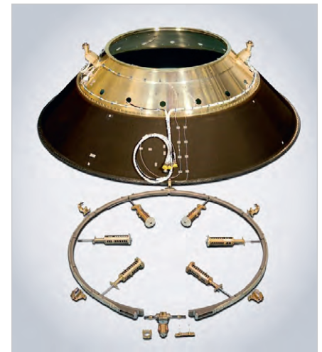
Рис. 16. Типичный адаптер космического аппарата
