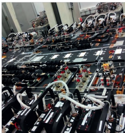
Рис. 11. Модуль контроллера КА SES-10
