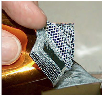
Рис. 20. Защитная плёнка для РЭА космических аппаратов и их внешних антенн
