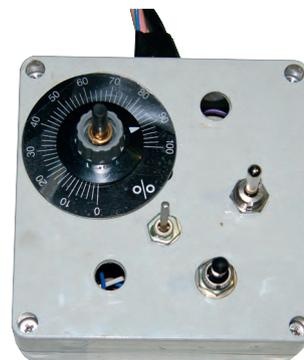
Рис. 3. Технологический пульт управления с ручным задатчиком положения штока пневмоцилиндра-позиционера
