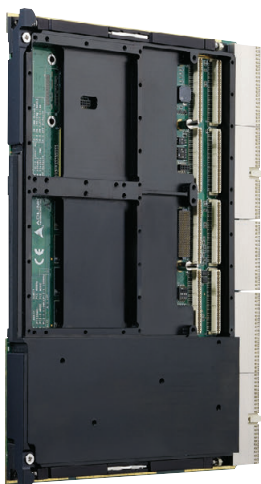
Рис. 5. CompactPCI-модуль с кондуктивным теплоотводом СТ-61
