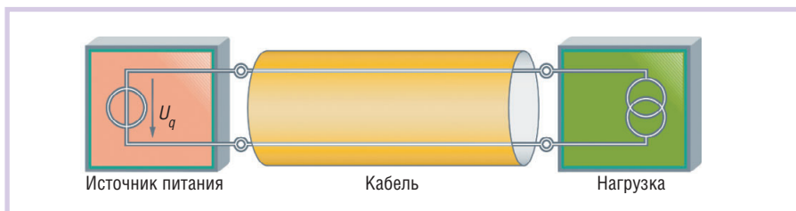
Рис. 3. Электрическая схема DART Power преднамеренно упрощена и содержит только источник питания, кабель и полезную нагрузку
