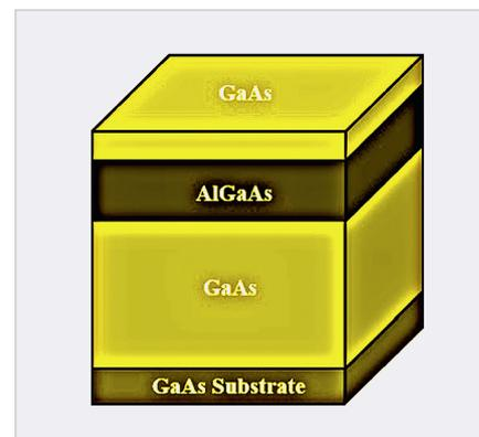
Рис. 2. Схема гетероструктуры 2D на основе AlGaAs/GaAs
