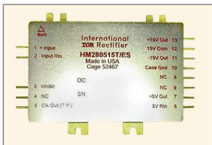
Рис. 2. DC/DC-преобразователь HM280515T/ES в корпусе 71 × 51 × 11 мм
