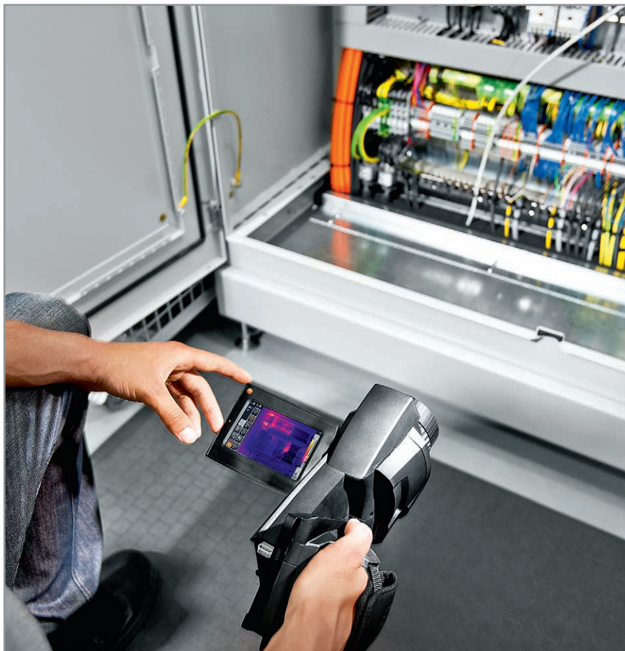
Рис. 2. Поворотная рукоятка тепловизора testo 885 обеспечивает максимум удобства при проведении обследований в труднодоступных местах
