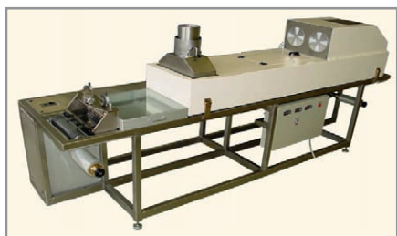
Рис. 2. Установка литья подложек на плёнку фирмы КЕКО (Словения)
