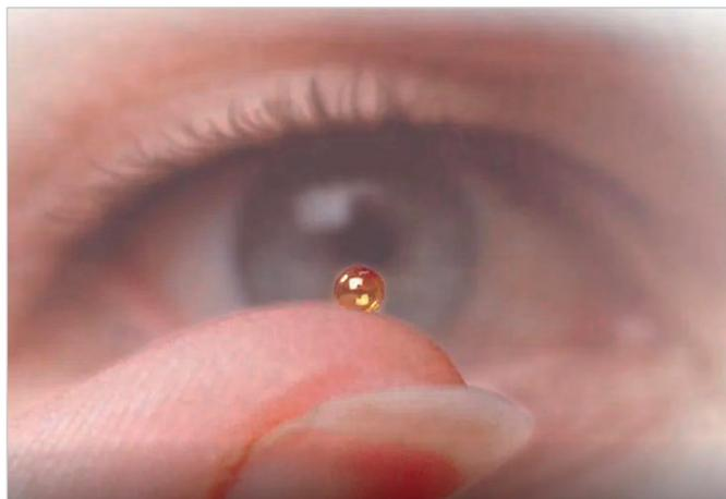
Рис. 10. Топливная мишень из дейтериево-тритиевой смеси в золотой оболочке (Lawrence Livermore National Laboratory)
