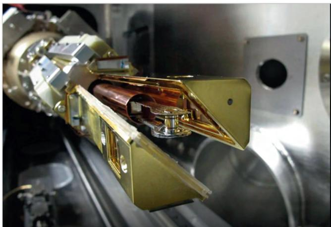
Рис. 9. Внешний вид механизма, удерживающего топливную мишень. Фото: Lawrence Livermore National Laboratory
