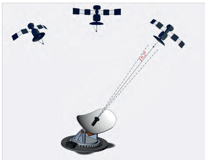
Рис. 1. Схема взаимодействия подвижного терминала с геостационарной спутниковой группировкой
