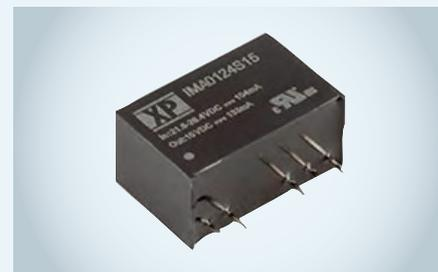
менного тока и два средства защиты пациента 2×MOPP при рабочем напряжении 125 В переменного тока с электрической прочностью изоляции между входными и выходными цепями 4000 В переменного тока. Все модели соответствуют требованиям по безопасности медицинского электрического оборудования в соответствии с международными стандартами 60601-1 и характеризуются низким током утечки на пациента 2 мкА.
