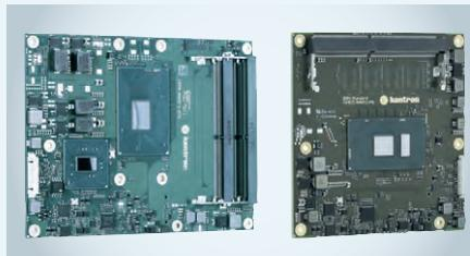
Несмотря на свои малые размеры, оба модуля обеспечивают более высокие показатели производительности и графики благодаря новейшим процессорам Intel Core и Intel Xeon 7-го поколения (кодовое название – Kaby Lake).
