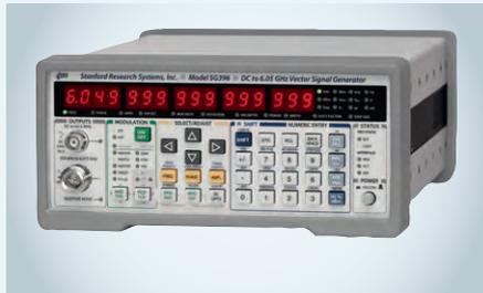
Генератор ВЧ-сигналов SG396 (номер в ГРСИ 58775-14) использует метод синтеза частоты с рациональной аппроксимацией и импульсно-фазовой автоподстройкой (RAFS), что обеспечивает ультравысокое разрешение по частоте при низком уровне фазовых шумов ( $-114$  дБн/Гц на частоте 1 ГГц при отстройке 20 кГц).
