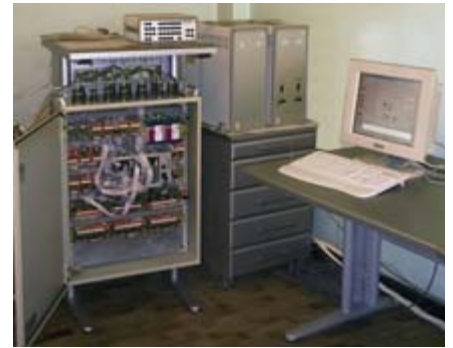
Рис. 3. КПА АУРК, КПА БХ, имитатор БХ и ПЭВМ для испытаний СЭС КА
