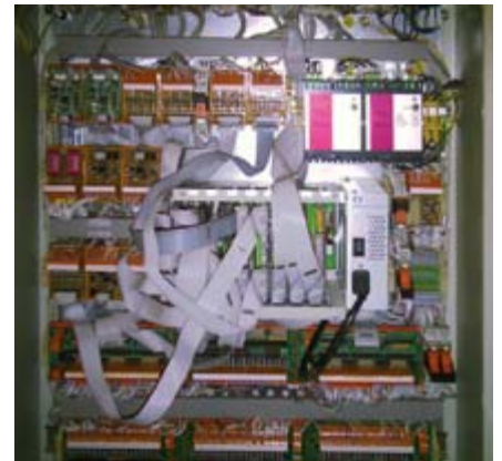
Рис. 4. Каркас с модулями MicroPC в составе аппаратуры КПА АУРК
