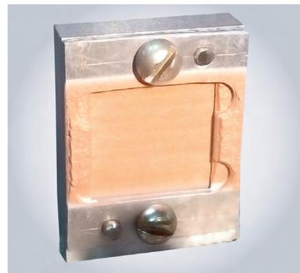
Рис. 3. Результат нанесения медного покрытия ХГН на подложку из ВК96 толщиной 0,3 мм
