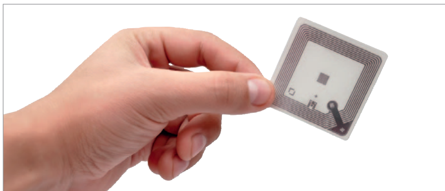
Рис. 1. Пассивная метка RFID
