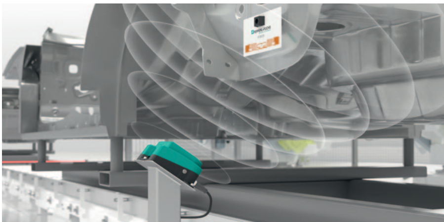
Рис. 4. Применение RFID-технологии на сборочном конвейере автозавода
