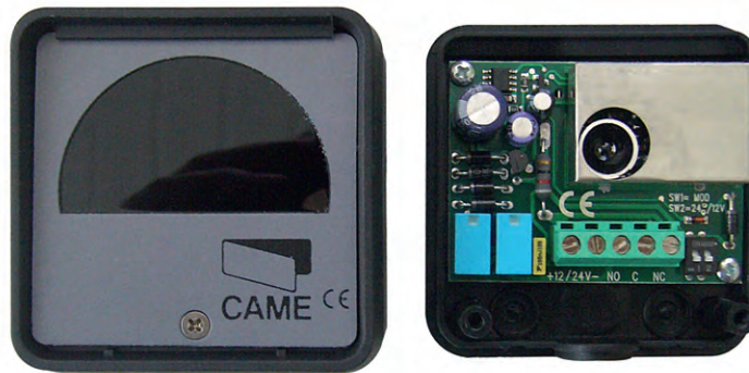
Рис. 3. Источник и приёмник (верхняя крышка снята) ИК-излучения
