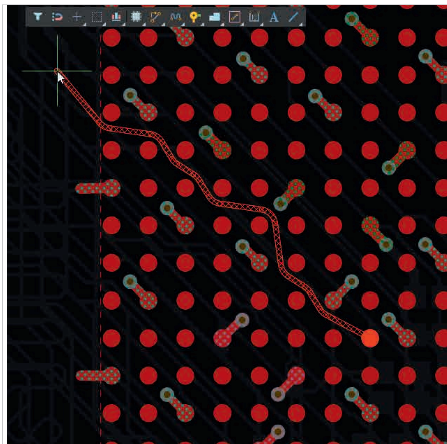
Рис. 1. Режим Snake Routing интерактивной трассировки
