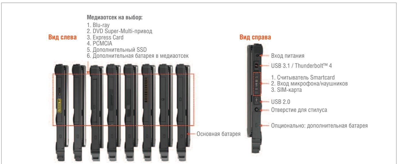
Рис. 5. S410G4 вид слева (медиаотсек) и справа
