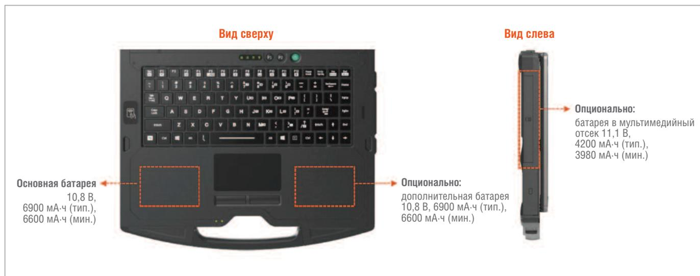
Рис. 2. Три варианта батарей: основная, дополнительная и в мультимедийный отсек
