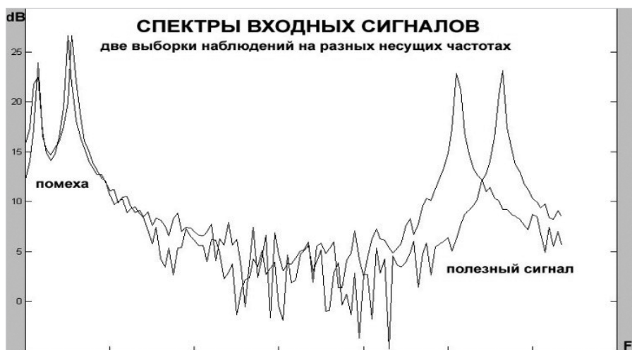
Рис. 6. Спектральное представление сигналов дискретной двухкомпонентной помехи с доплеровскими частотами компонент 10 Гц и 20 Гц и полезного сигнала с доплеровской частотой 200 Гц на входе. Амплитуды спектра в децибелах (dB), частота F в герцах с метками через 40 Гц. Две выборки на разных несущих частотах: 500 МГц и 550 МГц
