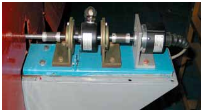
Рис. 3. Общий вид блока шифраторов, соединённого с валом шкива ШПУ
