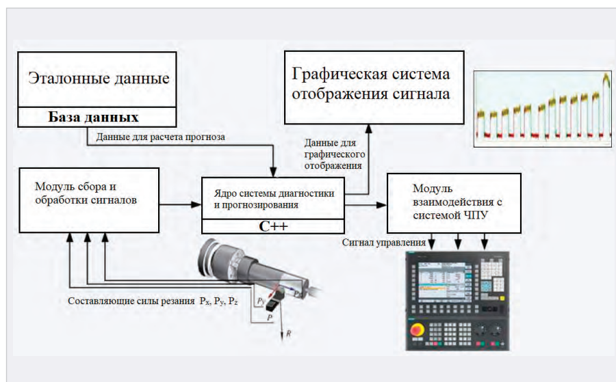
Рис. 2. Архитектурная модель системы диагностики и прогнозирования состояния режущего инструмента в реальном времени
