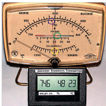
Рис. 7. Сравнение показаний устройства с показаниями прибора БМ 2
