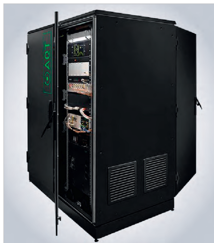
Рис. 6. Квантовый вычислительный блок на кубитах с ионными ловушками австрийской фирмы AQT
