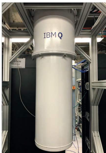
Рис. 4. Внешний вид квантового процессора IBM, размещённого внутри криогенной установки «Oxford Triton dilution refrigerator»
