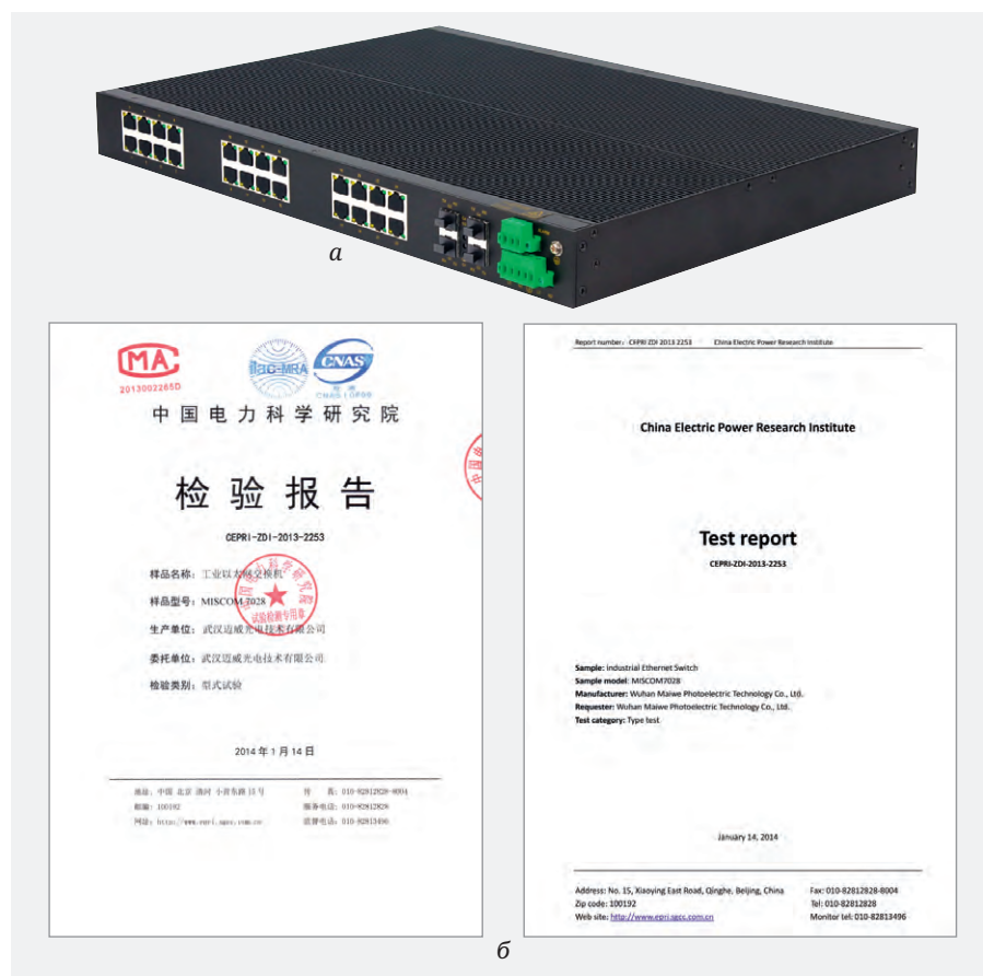
Рис. 7. Промышленный коммутатор серии MISCOM7028, ориентированный на применение в энергетике: а – внешний вид; б – тест-репорт на соответствие стандарту DL/T1241-2013 (Power Industry Ethernet Switch Technical Specifications)
