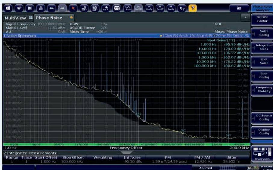
Рис. 2. Фазовые шумы ГК359-ТС
