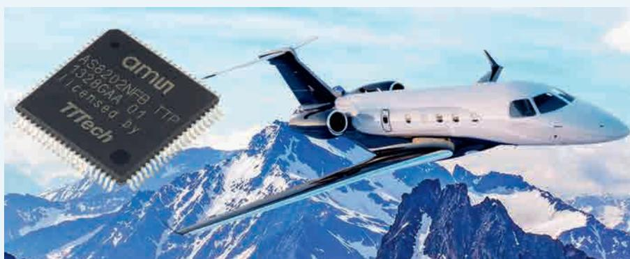
в синхронном режиме и 4 Мбит/с в асинхронном, имеет два канала с резервированием и работает в температурном диапазоне  $-40...+125^{\circ}\text{C}$ .
