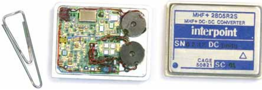
Рис. 3. Внешний вид конструкции интегрально-гибридного DC/DC-преобразователя серии MHF+ (представлен вариант исполнения без крепёжных фланцев, крышка снята для проведения испытаний)
