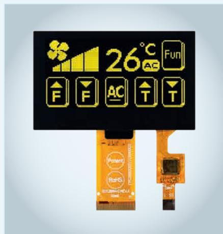
Анонсируемый OLED – это модуль со встроенным контроллером SSD1309, который поддерживает 8-битный параллельный интерфейс, I<sup>2</sup>C и 4-Wire SPI-интерфейс 6800/8080. Напряжение питания для Logic – 3 В, напряжение питания для дисплея – 13 В. Модель REX012864G имеет встроенный контроллер GT911 для ёмкостной сенсорной панели GT911, который поддерживает интерфейс I<sup>2</sup>C, одну точку касания для СТР.
