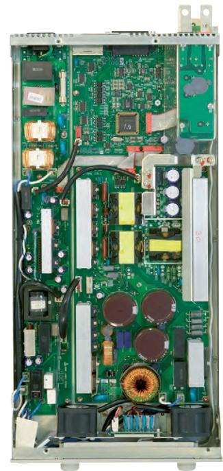
Рис. 9. Внешний вид конструкции программируемого ИВЭП GENH30-25 (вид сверху, защитная крышка снята)
