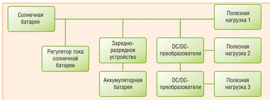
Рис. 1. Упрощённая структурная схема распределённой системы электропитания космического аппарата
