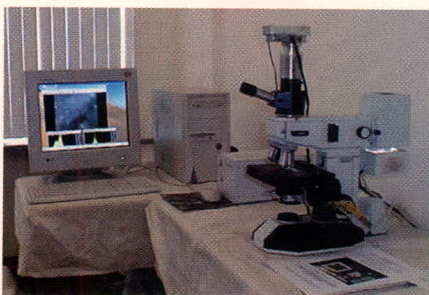
Рис. 7. Флюоресцентный микроскоп, подставка для сканирования объектов, видеокамера и компьютер с нейросетевым программным обеспечением
