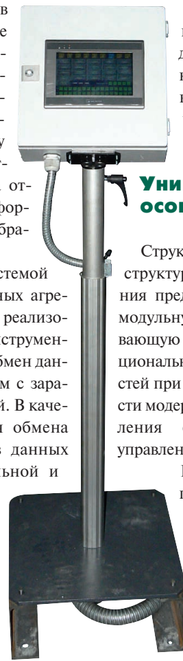
Рис. 7. Пульт контролёра ОТК
