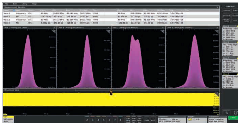
Рис. 1. Измерение частоты и TIE с помощью осциллографа смешанных сигналов Tektronix серии 5 с полосой пропускания 2 ГГц
