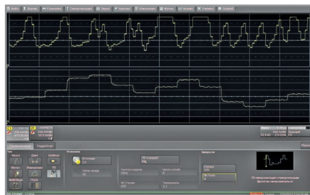
Рис. 10. Просмотр сложного телевизионного сигнала и его выделенной части
