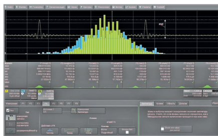
Рис. 12. Осциллограмма импульса \sin(x)/x и его автоматических и статистических измерений
