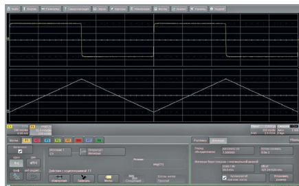
Рис. 17. Пример операции интегрирования осциллограммы меандра
