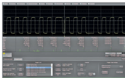
Рис. 16. Панель синхронизации и параметров режима TriggerScan
