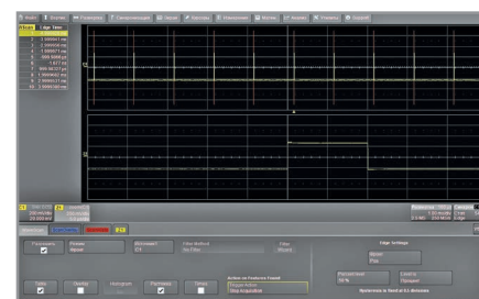
Рис. 15. Функция WaveScan нашла положительные фронты коротких импульсов
