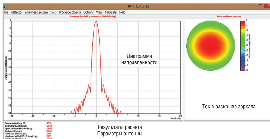
Рис. 4. Сечение диаграммы направленности (слева) и ток в раскрыве апертуры зеркальной антенны (справа), рассчитанные в программе Mirror
