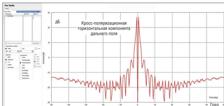
Рис. 11. Кросс-поляризационная составляющая диаграммы направленности офсетной зеркальной антенны [8] (расчёт в FEKO)
